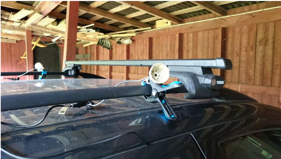
Kuva 3.3. Auton katolle sijoitetut mikrofonit tuulisuojineen.
