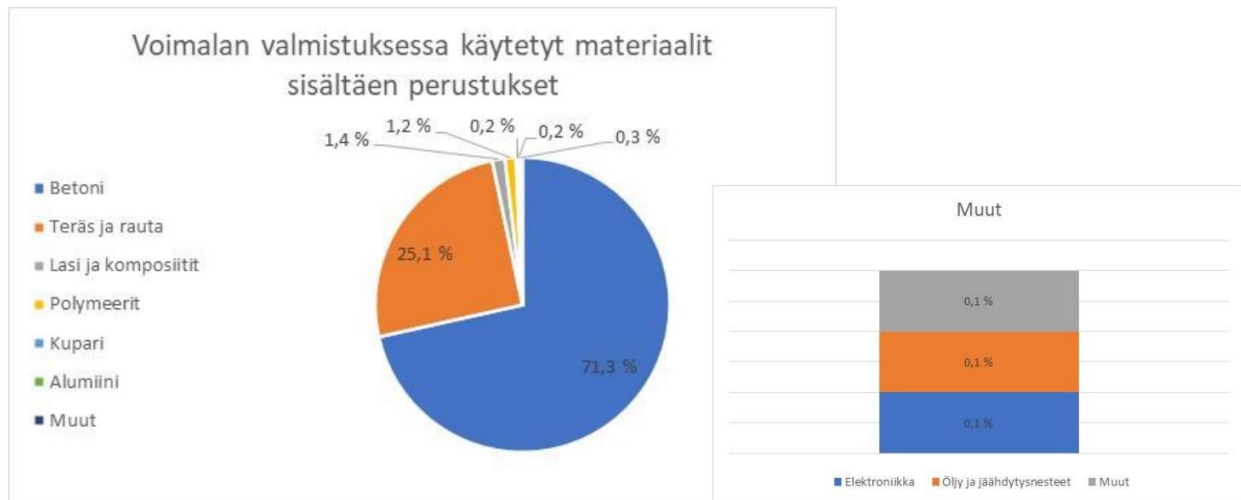
Kuva 150. Esimerkki voimalan valmistuksessa käytettävistä materiaaleista sisältäen voimalaperustukset ja niiden osuus koko voimalan massasta Voimalamalli Vestas V150-4,2 MW (Vestas 2022b)
