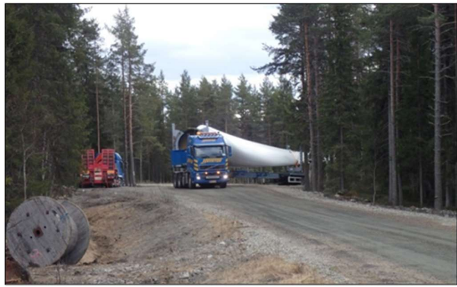
Kuva 73. Vasemmalla kuvassa on esimerkki tuulivoimapuiston rakennus- ja huoltotiestä. Teitä käytetään muun muassa betonin, soran ja voimaloiden komponenttien kuljetuksiin sekä tuulivoimapuiston käyttövaiheessa huoltoajoihin. Maakaapeli sijoitetaan ojakaivantoon tien reuna-alueelle. Oikealla kuvassa tuulivoimalan osia kuljetetaan erikoiskuljetuksina. (Kuvat: FCG).
